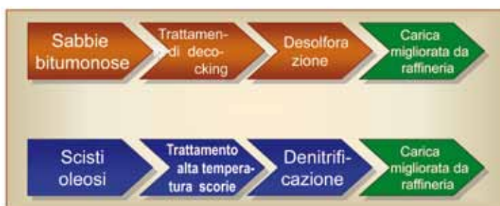
Fig. 31. – Analogie tra la catena di trattamento di sabbie bituminose e greggio da scisti (54) .
