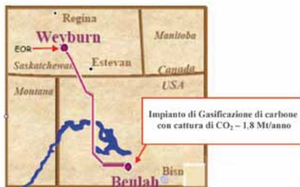
Fig. 28. – Campo sperimentale di Weyburn-Canada per la utilizzazione del CO 2 nella enhanced oil recovery.
